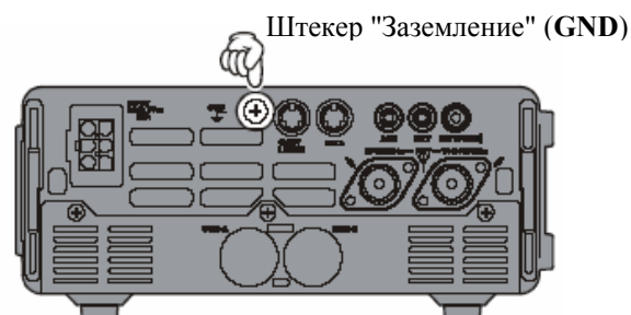
Неправильное заземление
