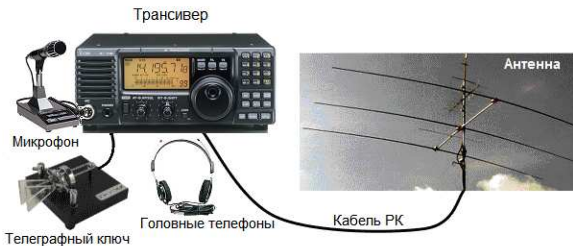
Рис.2.2. Элементы любительской радиостанции
